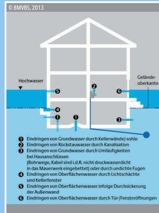
Um das Wasser vom Gebäude fernzuhalten, gibt es eine Reihe sinnvoller Maßnahmen am Gebäude selbst wie z.B. Rückstauklappen, Abdichtungen, Dammbalken etc. Informieren Sie sich z.B. anhand der **Hochwasserschutzfibel** unter:
