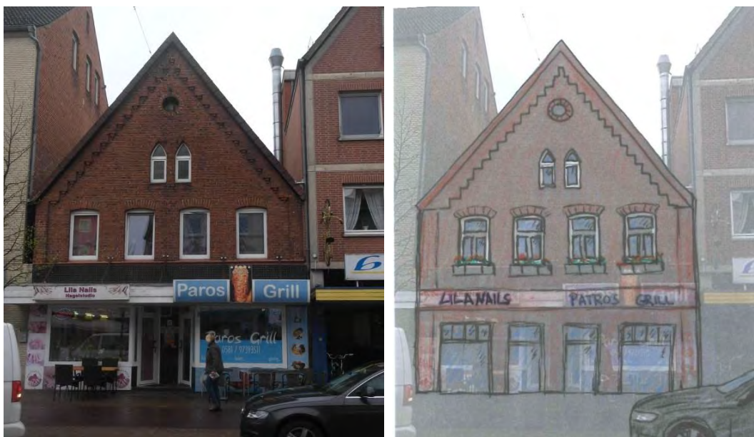
Abbildung 20: Beispiel Gebäude Lüneburger Straße Ost, Rückbau der überformten Erdgeschosszone; Ersatz der Erdgeschossfenster durch angepasste Formate und Ersatz der unangepassten Materialien im EG, um Bezug zu Obergeschossen wiederherzustellen; Werbung zurückhaltender gestalten, als Einzelbuchstaben auf Fassade
